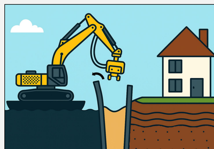
1) Vervormen van bouwkuipdamwand
